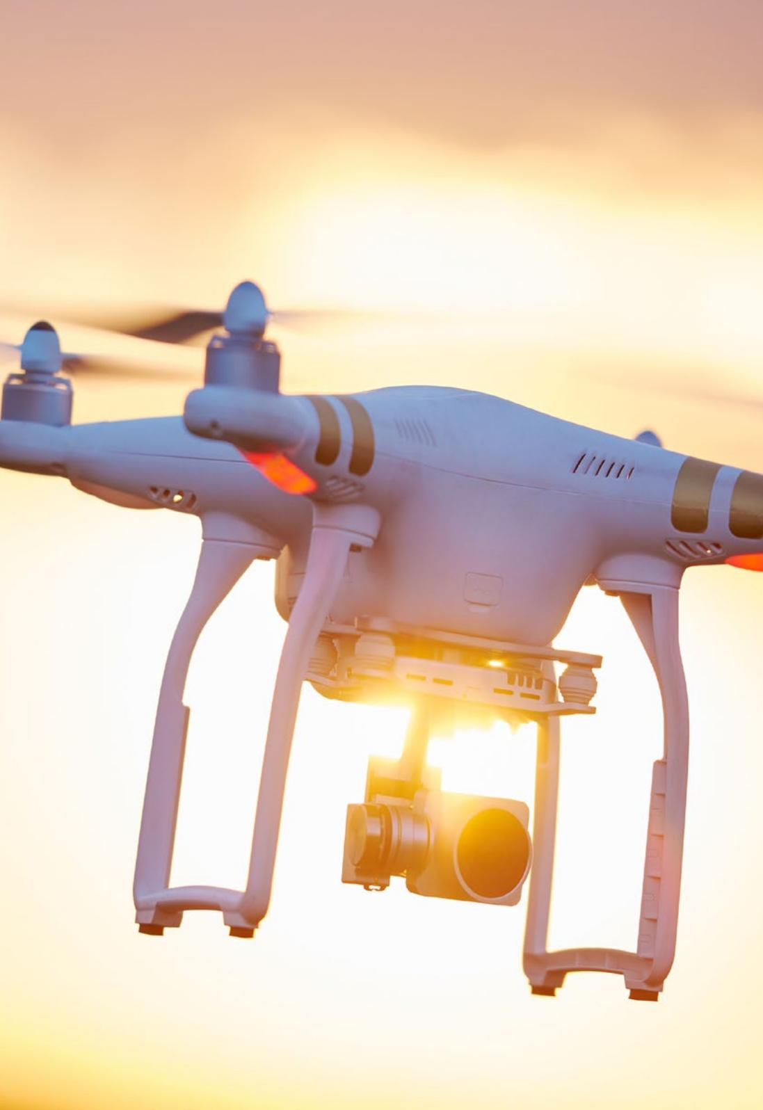
La precipitación, ya sea en forma de lluvia, nieve o hielo, puede afectar significativamente las operaciones realizadas con drones. De hecho, es capaz de interferir con los sistemas electrónicos del RPAS y reducir la visibilidad del operador, lo que provoca que sea difícil controlar el dron de manera efectiva.
