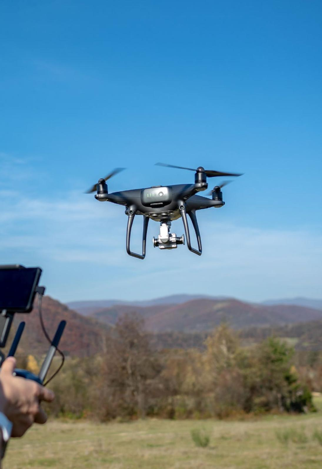
La navegación manual de un dron requiere una atención constante del operador. Este debe monitorear continuamente la ubicación y la velocidad del RPAS para garantizar que permanezca en una zona de vuelo segura. Además, los operadores deben cumplir con las regulaciones de la aviación, que incluyen limitaciones en la altura máxima de vuelo, restricciones de espacio aéreo y la necesidad de mantener una distancia segura de otros objetos en el aire.
